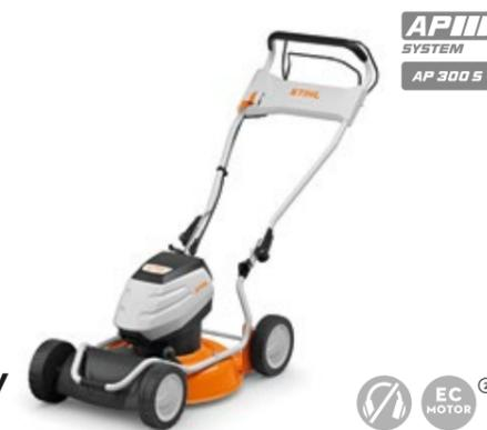
Leichter und wendiger Akku-Mulchmäher mit 46 cm Schnittbreite für mittelgroße Rasenflächen. Achsweise Schnitthöhenverstellung, Quick-Fix-Schnellspanner und klappbarer Holm. Elektrischer Vario-Radantrieb für komfortables Arbeiten. Die maximale Arbeitsgeschwindigkeit kann über einen Hebel am Holm variabel in sechs Stufen eingestellt werden. Mit zwei aktiven Akkuschächten zur seriellen Entladung.
